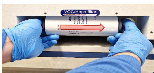
Εικόνα 12.2 Διαδικασία εισαγωγής και αφαίρεσης φίλτρου VOC/HEPA
